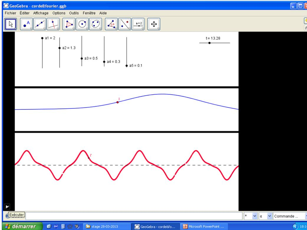
On retrouve une onde progressive qui se propage dans la corde par **superposition d'ondes stationnaires** de fréquence  $\mathbf{f_n = n \times f_1}$  avec :  $f_1 = \frac{c}{2L}$
