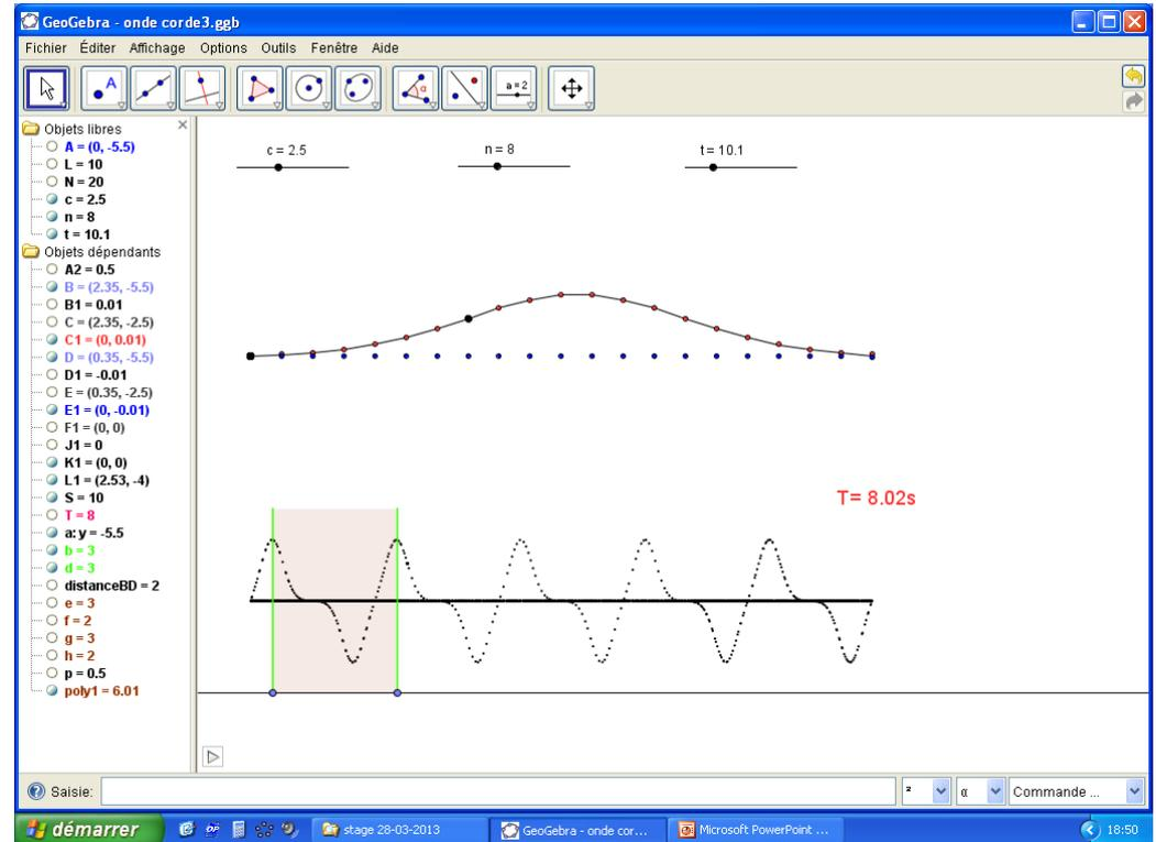
On peut en déduire ce qui est facilement observable expérimentalement : une corde **plus courte et plus tendue** ( $c$  augmente avec la tension) émet un son **plus aigu** car de fréquence plus élevée.
